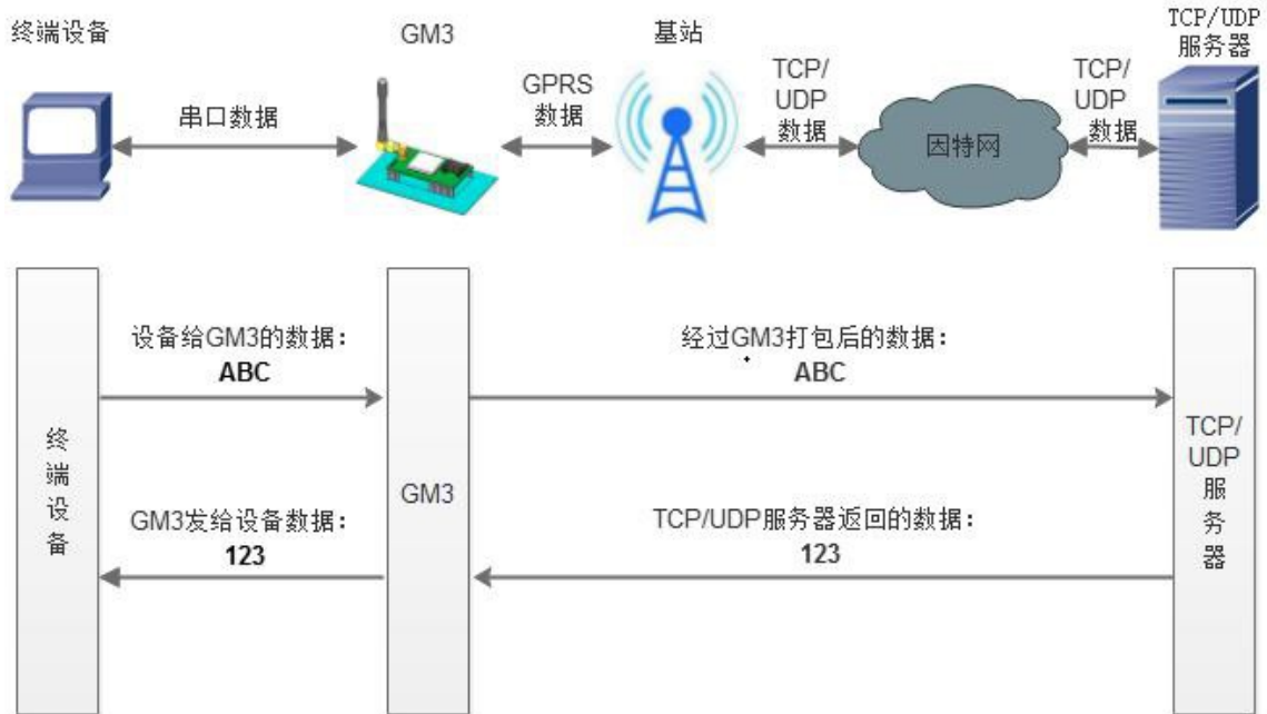
图 2 网络透传模式 用户不需要关注串口数据与网络数据包之
